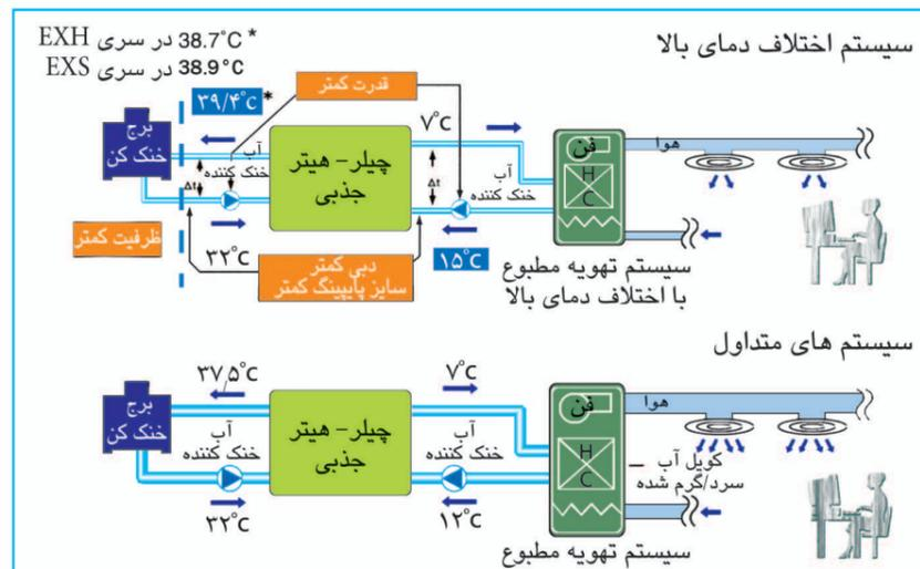
گردش کم شود. برای این منظور دمای خروجی آب خنک کننده بیشتر شده تا اختلاف دمای مورد نظر بیشتر شود و میزان توان مصرفی مورد نیاز برای انتقال آب خنک کننده کمتر می شود.
