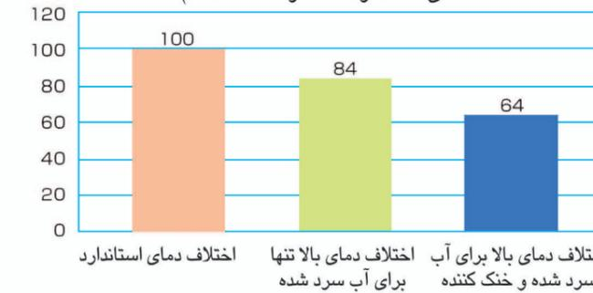
دبی آب سرد شده و خنک کننده با بکارگیری سیستم اختلاف دمای بالا کاهش خواهد یافت (در سری V)
